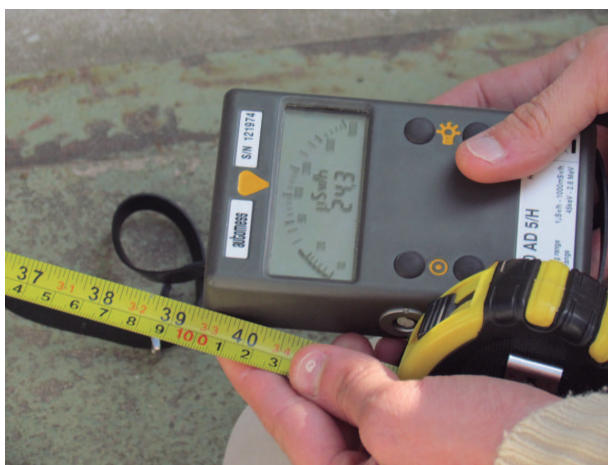
Inspección de bulto de transporte de material radiactivo
